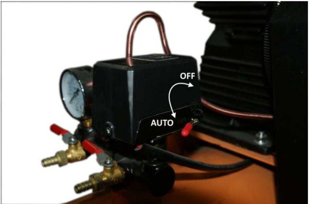
Рисунок. Переключатель включения / остановки компрессора.
