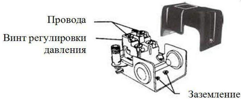
Рисунок. Корпус прессостата.
