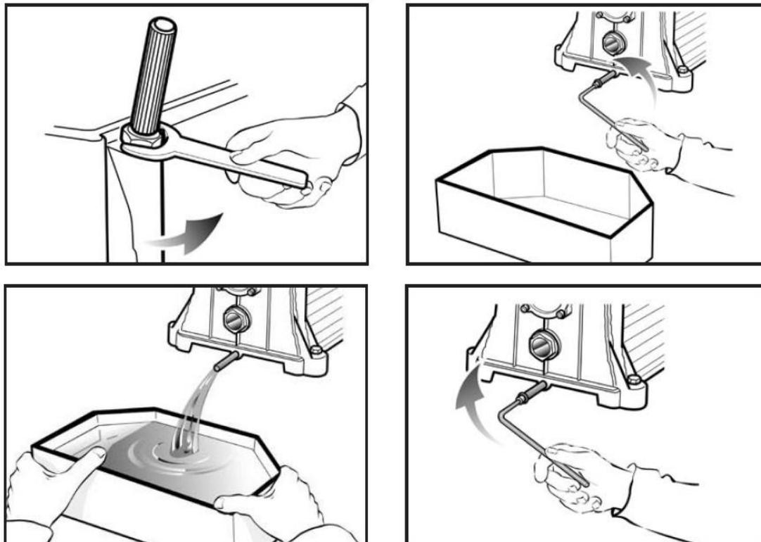
Рисунок. Слив отработанного компрессорного масла.
