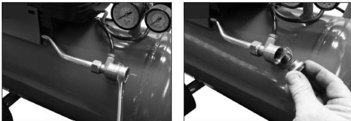
Рисунок. Очистка датчика давления воздуха.
