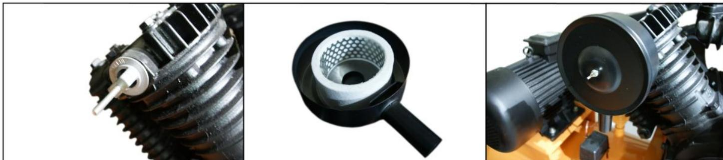
Рисунок. Установка воздушного фильтра.
